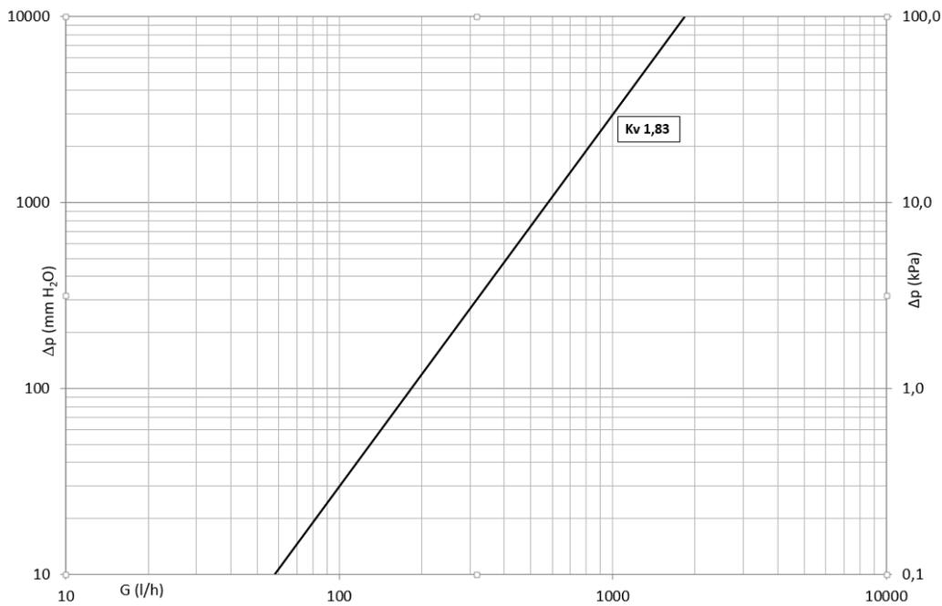
Le diagramme ci-contre montre les pertes de charge d'un couple de collecteurs **703\_\_M** ou **704\_\_Q** en considérant une seule sortie. Kv= 1.83
